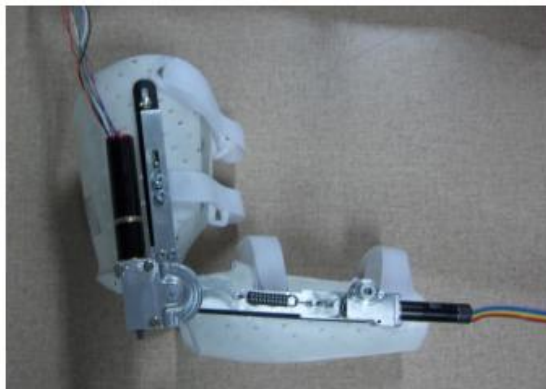
Figura 5 - Protótipo criado por Vanderniepen et al. (2008) que utiliza uma mola pré-tensionada
