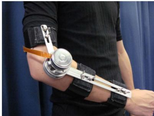
Figura 3 - Protótipo desenvolvido por Seki et al. (2011) utilizando-se uma junta rotacional e processamento de sinal elétrico
