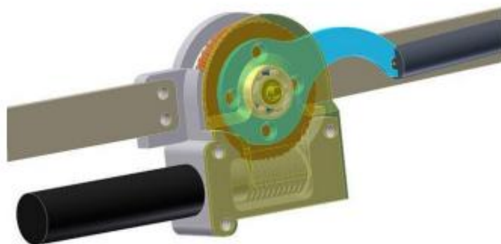
Figura 4 - Desenho em CAD do protótipo criado por Vanderniepen et al. (2008) com um pequeno atuador na região inferior
