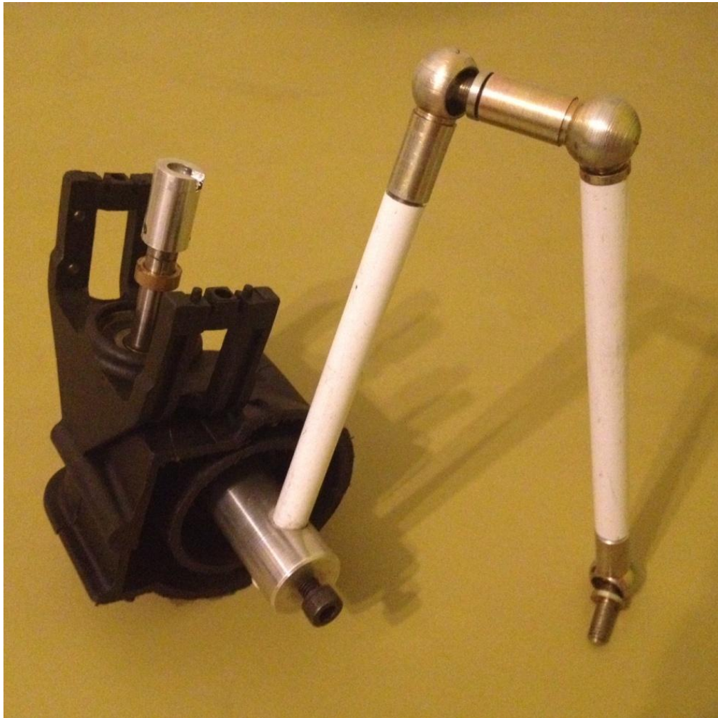
Figura 23 - Detalhe da caixa de redução e da cadeia seriada do exoesqueleto
